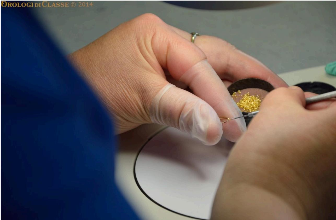
Infine vengono effettuati altre operazioni sempre sul bilanciere: prima l'inserimento delle viti, poi l'accoppiamento con la molla della spirale libera.
